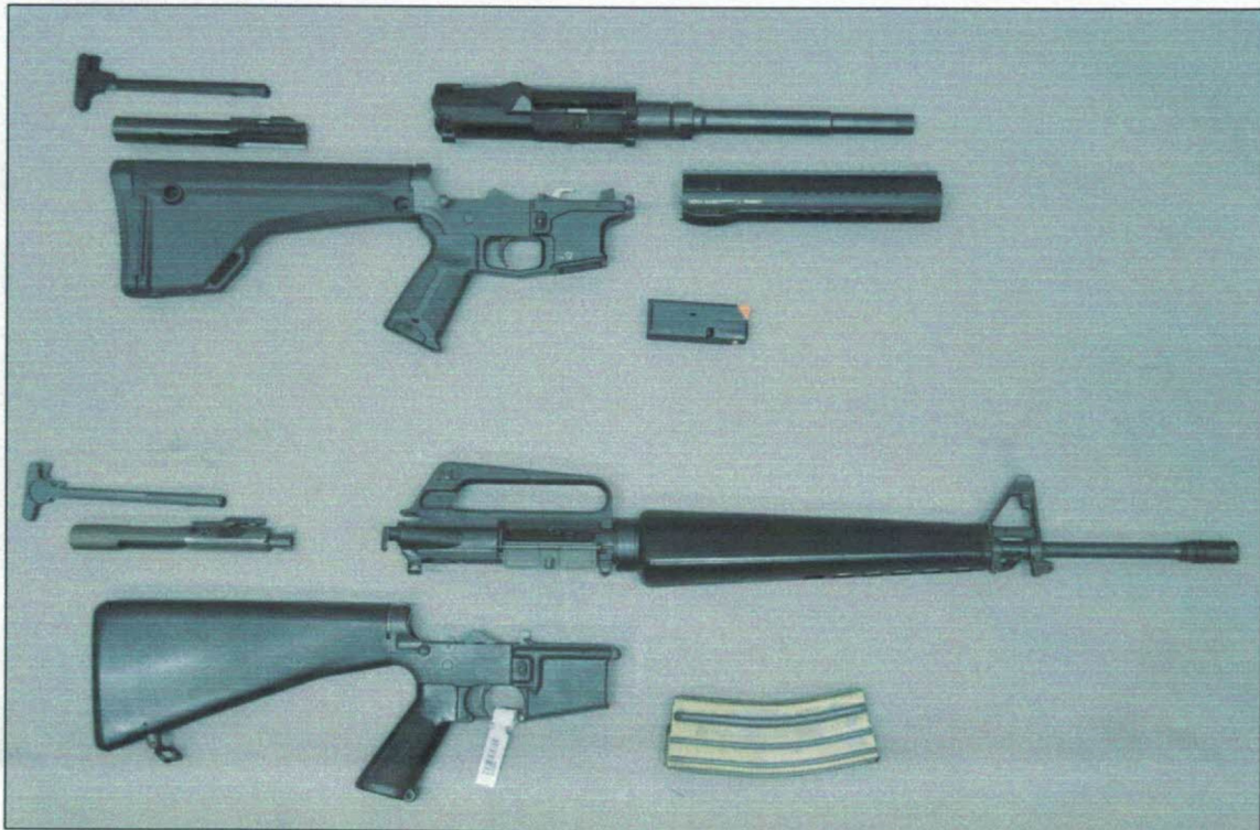
Abbildung 5: Vergleichsansicht rechte Seite, oben die halbautomatische „The 9ers-Sport-C“, unten die vollautomatische „AR15“, beide zerlegt in die jeweiligen Hauptgruppen
